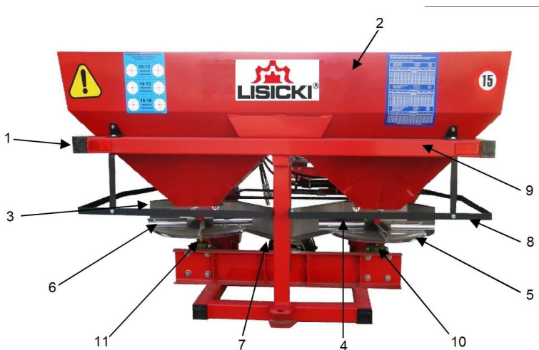
Рис. 1. Двухдисковой рассеиватель удобрений типа N 067 ( вид сзади )
